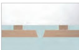
Kaschieren der Hohlkammer durch Schrägschnitt.
