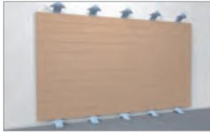
Aufgrund des hohen Diffusionswiderstands von Profilen, hergestellt aus Resysta, ist die Fassade in jedem Fall zu hinterlüften. Der Hinterlüftungsabstand muss mindestens 20 mm betragen. Der Hinterlüftungsabstand darf nicht verengt werden. Der Abstand muss durchlaufend min. 20 mm breit sein.
