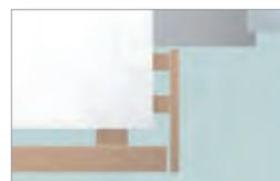
Anschlüsse können auch mit verschiedenen Profilen, hergestellt aus Resysta, erfolgen, z.B. Fensterlaibung mit FP 200/5. Bei der Gestaltung der Anschlüsse ist die thermische Ausdehnung von Profilen aus Resysta zu berücksichtigen.
