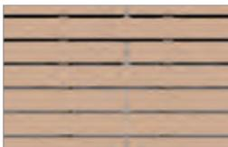
Wir empfehlen die Bildung von versetzten Fugen (Schiffsverband).
