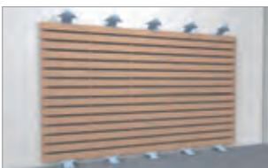
Aufgrund des hohen Diffusionswiderstands von Profilen aus Resysta ist die Fassade immer zu hinterlüften. Der Hinterlüftungsabstand muss mindestens 20 mm betragen und darf nicht verringert werden. Die Be- und Entlüftungsöffnungen müssen durchlaufend mindestens 20 mm breit sein.
