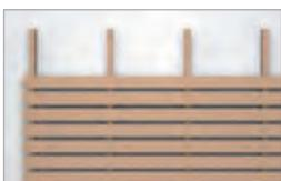
Die empfohlenen maximalen Befestigungsabstände richten sich nach der nachfolgenden Tabelle. Diese sind so gewählt, dass die Durchbiegung maximal 1/300 der Befestigungsabstände entspricht. Die Durchbiegung entsteht aufgrund des Eigengewichts der Profile und der unterschiedlichen Erwärmung der einzelnen Materialschichten bei Sonneneinstrahlung.
