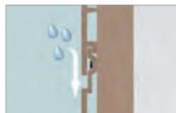
Bei horizontaler Montage sind die Profile so zu montieren, dass ein geregelter Wasserablauf stattfindet.
