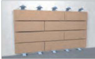
Aufgrund des hohen Diffusionswiderstands von Profilen, hergestellt aus Resysta, ist die Fassade immer zu hinterlüften. Der Hinterlüftungsabstand muss mindestens 20 mm betragen und darf nicht verringert werden. Die Abstände müssen durchlaufend mindestens 20 mm breit sein.
